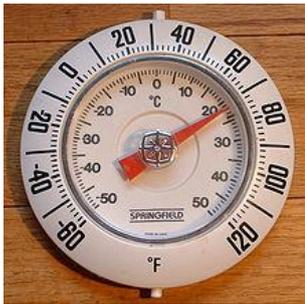
Il contient deux lames soudées l'une contre l'autre, chacune faite d'un métal différent. Si on enroule ce bilame en "escargot", il se déforme quand la température monte ou descend : il ne reste plus qu'à lire à quelle température correspond la déformation en ajoutant une aiguille au bout de la spirale et un cadran gradué !
