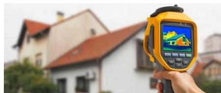
En utilisant des capteurs à infrarouge dans une caméra (on parle de caméra infrarouge ou de caméra thermique), on peut savoir à quelle température est chaque pixel... et donc savoir où une maison "perd" la chaleur du chauffage en hiver...
