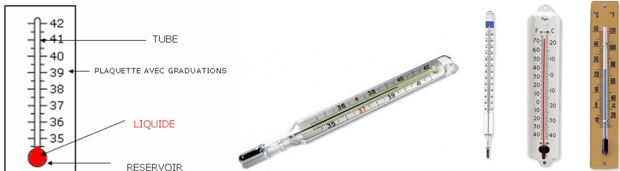
Pour un thermomètre "météo" qui peut indiquer la température entre  $-30^{\circ}\text{C}$  et  $+50^{\circ}\text{C}$  par exemple, on fera pareil mais avec un réservoir où on met assez de liquide qui occupe tout le réservoir quand il est à  $-30^{\circ}\text{C}$  et un canal assez long et fin pour que le liquide arrive tout en haut quand il fait  $+50^{\circ}\text{C}$ .
